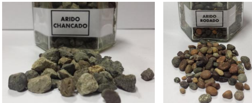
Figura 3.1.- Árido chancado (izquierda) y árido rodado (derecha), (Uribe, 2015).
