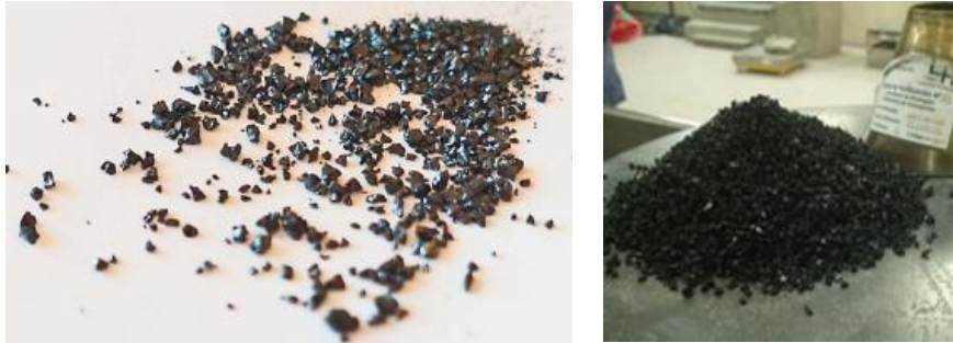
Figura 3.3.- Residuos utilizados como reemplazo parcial del árido fino de hormigones. Escoria de fundición de cobre (izquierda) y caucho granulado de neumático fuera de uso (derecha), (Archivo fotográfico Laboratorio de Hormigones UdeC, 2021).
