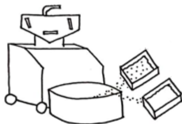
Figura 1 Mezcla de arena más cemento en betonera
