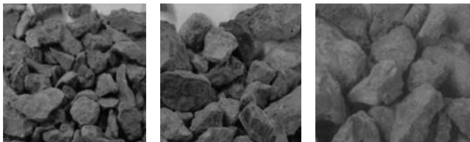
Figura 3.2.- Áridos reciclados provenientes de la trituración de hormigones. Tamaño 6,3-9,5 mm (izquierda), 9,5-12,5 mm (centro) y 12,5-19 mm (derecha), (Letelier et al., 2014).
