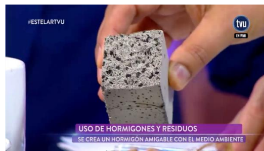
Figura 18. Probeta de mortero con reemplazo parcial de arena por caucho granulado de neumáticos fuera de uso (Entrevista TVU a Prof. M. Pradena).
